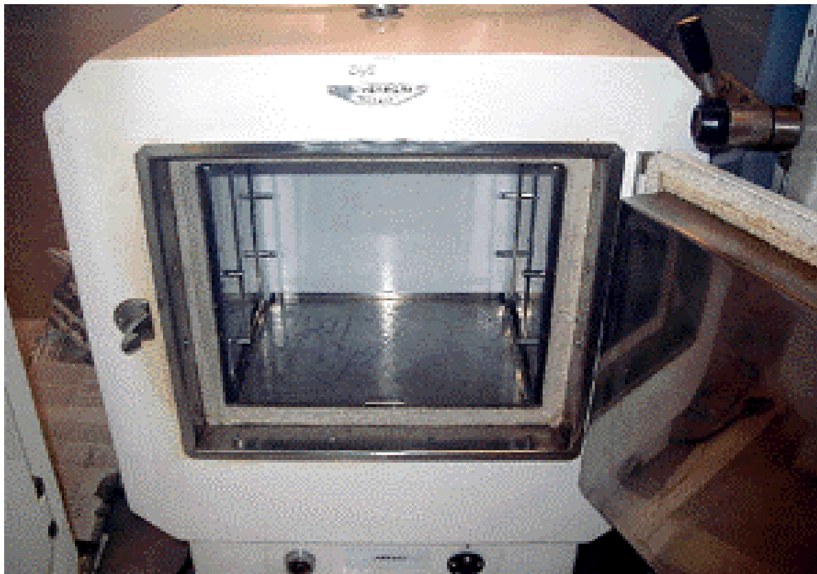
Figura 9. Muffola con guarnizione sportello in amianto
